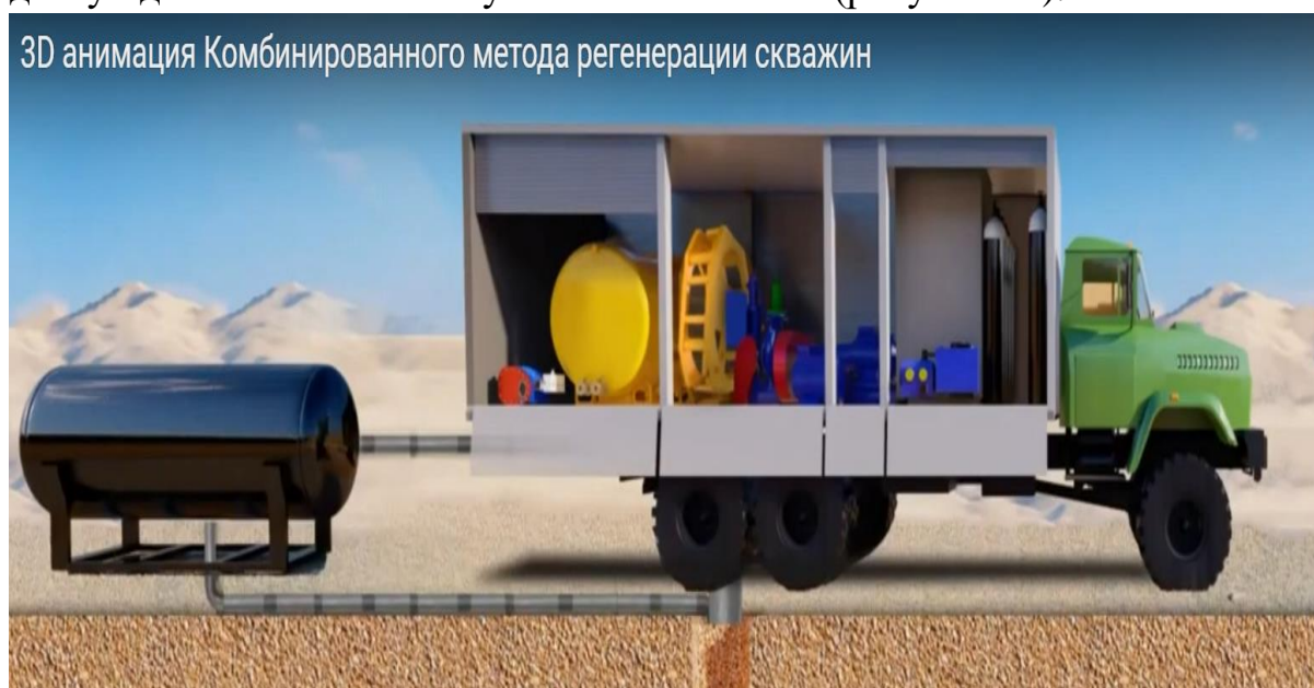
Рисунок 24. Передвижная установка химической обработки технологических скважин (вид сбоку)
