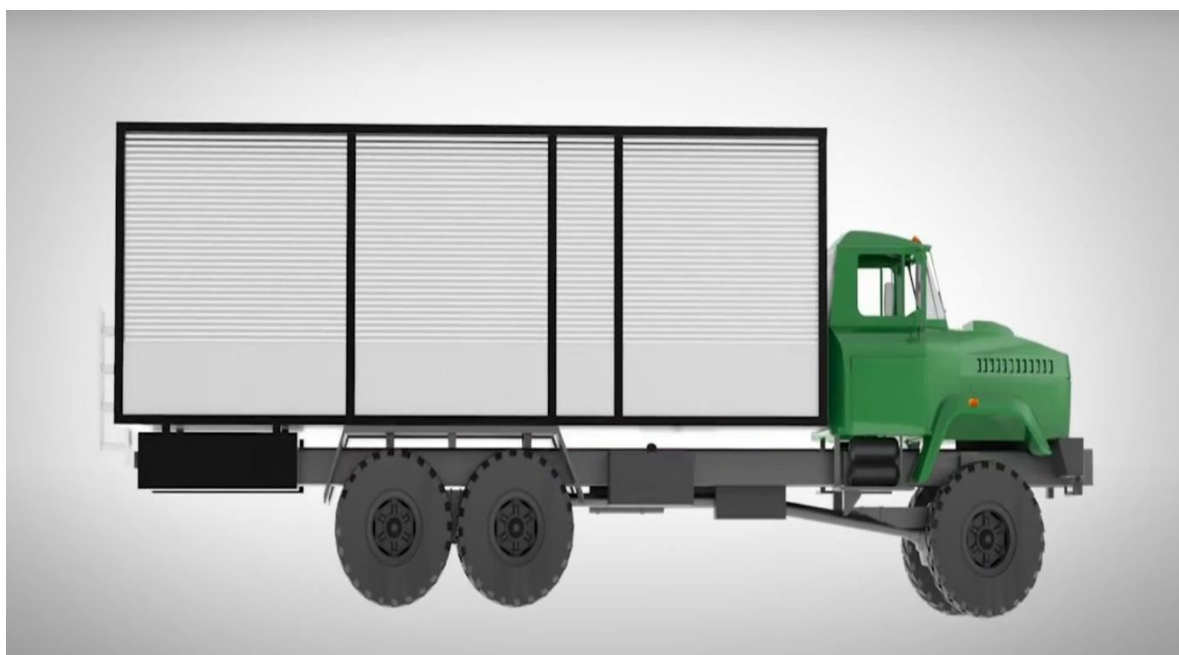
Рисунок 23. Проект передвижной установки для проведения комбинированной обработки непосредственно фильтровой части скважин на шасси автомашины КРАЗ 6446-03
