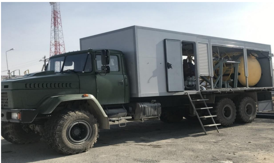
Рисунок 28. Общий вид передвижной установки после монтажа оборудования на рабочую платформу автомобиля КРАЗ 6446-03
